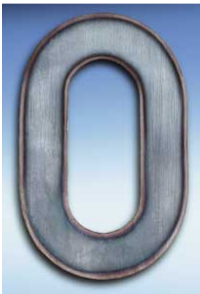
Abbildung 3: Längsschnitt durch ein einsatzgehärtetes Kettenglied.
