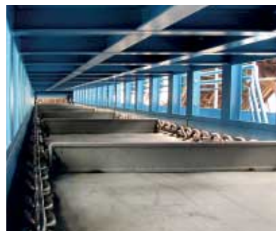
Abbildung 62: HEKO Ketten, Kratzer und Befestigungen im Untertrum
