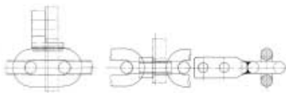
Abbildung 25: angeschweißte Mitnehmer für innenverzahnte und taschenverzahnte Kettenräder in Zweistranganlagen zum Anschrauben der Mitnehmer Typ AFS
