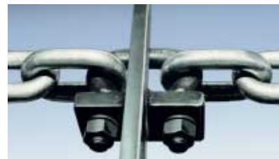
Abbildung 12: Mitnehmerbefestigung durch HEKO Kettenbügel Typ DIN 5699
