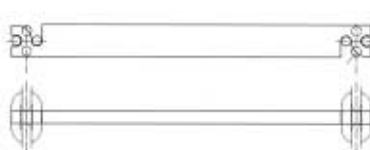
Abbildung 23: einschwenkbare Förderleisten für taschenverzahnte Kettenräder
