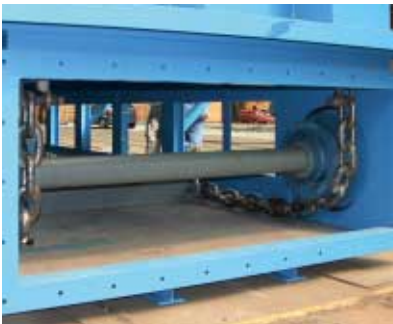
Abbildung 65: Antrieb, Spanneinheit und Umlenkung einer Nassschungsanlage mit HEKO Bauteilen
