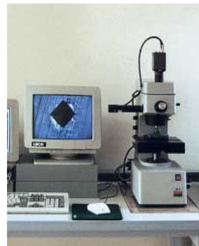
Abbildung 9: Härteprüfautomat (Archivierung der Härteprüfwerte inklusive der Härteverlaufskurven)
